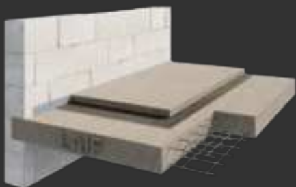
Стяжка 2-го этажа
