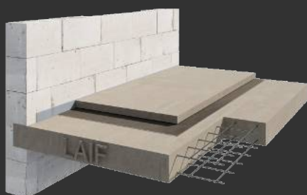
Стяжка 2-го этажа
