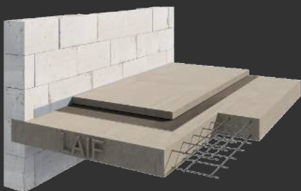
Стяжка 2-го этажа
