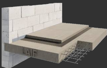
Стяжка 2-го этажа
